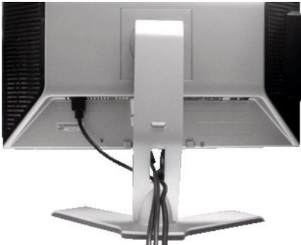
Después de conectar todos los cables necesarios al monitor y al ordenador (consulte [Conexión del monitor](#) para conectar los cables), utilice el orificio de gestión de los cables para organizar todos los cables como se muestra arriba.
